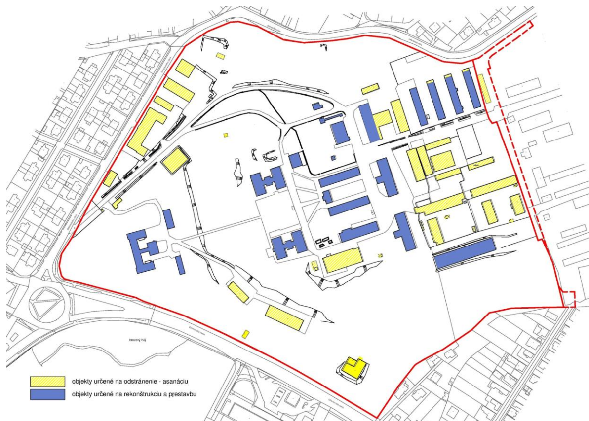
Obr. 11: Objekty určené na obnovu, prestavbu a odstránenie
